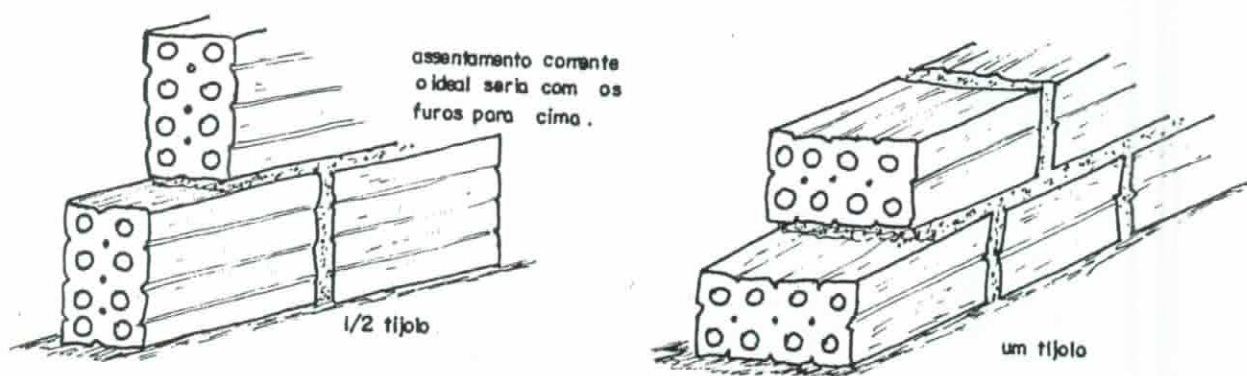
Figura 1 - Execução de alvenaria utilizando tijolos furados.
