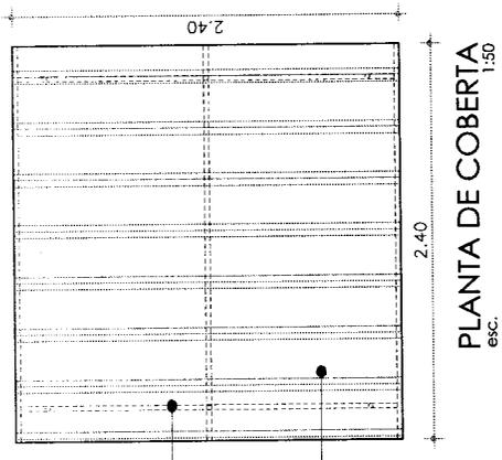
Projeção da estrutura em tubo de aço galvanizado
