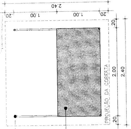
MONTANTE EM TUBO DE AÇO GALVANIZADO Ø=30mm Pintado em esmalte sintético, cor a definir
