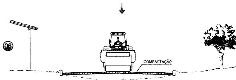
AS PEDRAS SOB A CAMADA DE AREIA DEVEM SER BATIDAS INICIALMENTE COM COMPACTADOR MANUAL TIPO PLACA VIBRATÓRIA E EM SEGUNDA PASSA-SE O ROLO COMPRESSOR, COMEÇANDO PELO PONTO DE MENOR COTA PARA O DE MAIOR COTA NA SEÇÃO TRANSVERSAL. O NÚMERO DE PASSADAS, ASSIM EXECUTADAS, É DE 3 VEZES NO MÍNIMO.
