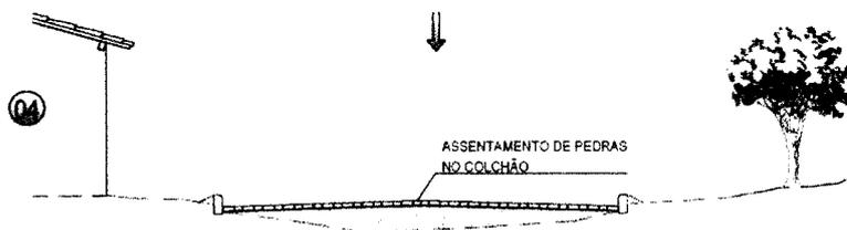
OS BLOCOS DE PEDRA TOSCAS SERÃO ASSENTES SOBRE O COLCHÃO DE AREIA EM LINHAS PERPENDICULARES AO EIXO DA PISTA, OBEDECENDO AS COTAS E ABaulamentos DO PROJETO EM TANGENTE. O ABaulamento SERÁ FEITO POR DUAS RAMPAS, OPOSTAS A PARTIR DO EIXO, COM DECLIVIDADE DE 3% SALVO OUTRA INDICAÇÃO DO PROJETO. NAS CURVAS, A DECLIVIDADE TRANSVERSAL SERÁ A INDICADA PELA SUPER-ELEVAÇÃO PROJETADA.
